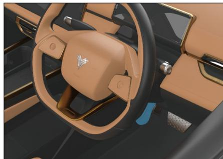
Para ajustar a coluna de direção, segure o volante e solte a alavanca de trava. Coloque a coluna de direção na posição necessária para suportar a remoção do ocupante e volte a travar a alavanca de trava.
