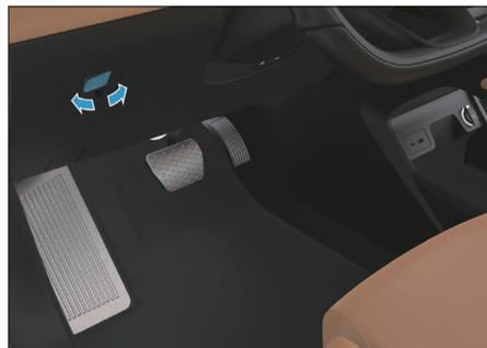
1. Quando o veículo estiver prestes a parar, pressione o pedal do freio e a velocidade irá descer para 0 km/h.
