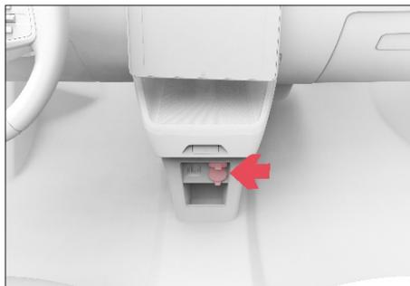
A fonte de alimentação a bordo está localizada sob o painel de instrumentos de controle central e pode ser utilizada para ligar equipamentos elétricos. Se não for utilizado, garanta que a tampa da tomada seja fechada.
