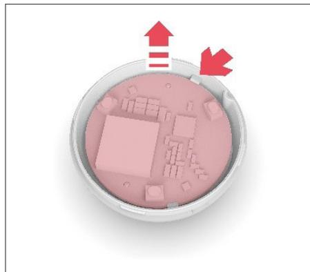
4 Levante a placa de circuito integrado na posição da seta e retire a mesma.
