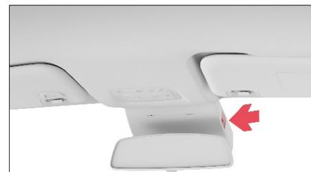
A interface USB do espelho retrovisor está localizada na parte lateral da caixa do espelho retrovisor e pode fornecer energia ao gravador de condução.
