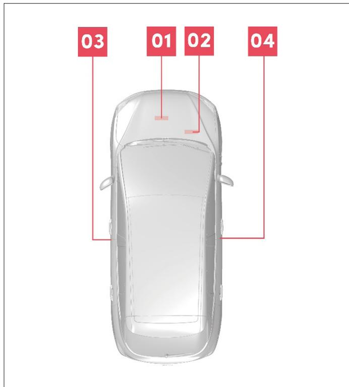
**01** Etiqueta para o modelo e o número do motor de acionamento: fixada na parte inferior do motor de acionamento, a informação inclui o modelo e o número do motor de acionamento.
