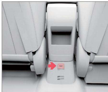
A interface USB traseira está localizada na parte traseira do painel de instrumentos auxiliar e suporta o carregamento de telefones celulares.
