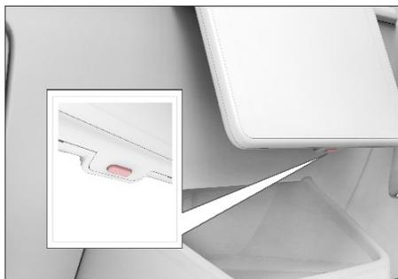
Pressione continuamente o botão na parte inferior da tela de controle central para reiniciar. Em caso de falha no sistema, pode-se tentar esta operação.
