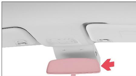
Ao levar a alavanca do espelho retrovisor para dentro, o espelho retrovisor interior será ajustado a posição anti-ofuscamento, de modo a reduzir o ofuscamento causado pelas luzes dos veículos atrás do seu veículo ao motorista.
