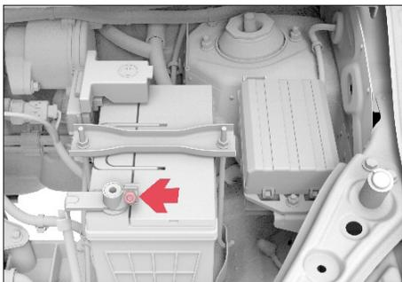
Depois de desligar a alimentação do veículo abra a tampa do compartimento frontal. Desligue o terminal negativo da bateria de baixa tensão (desligar e garantir que este não esteja ligado).
